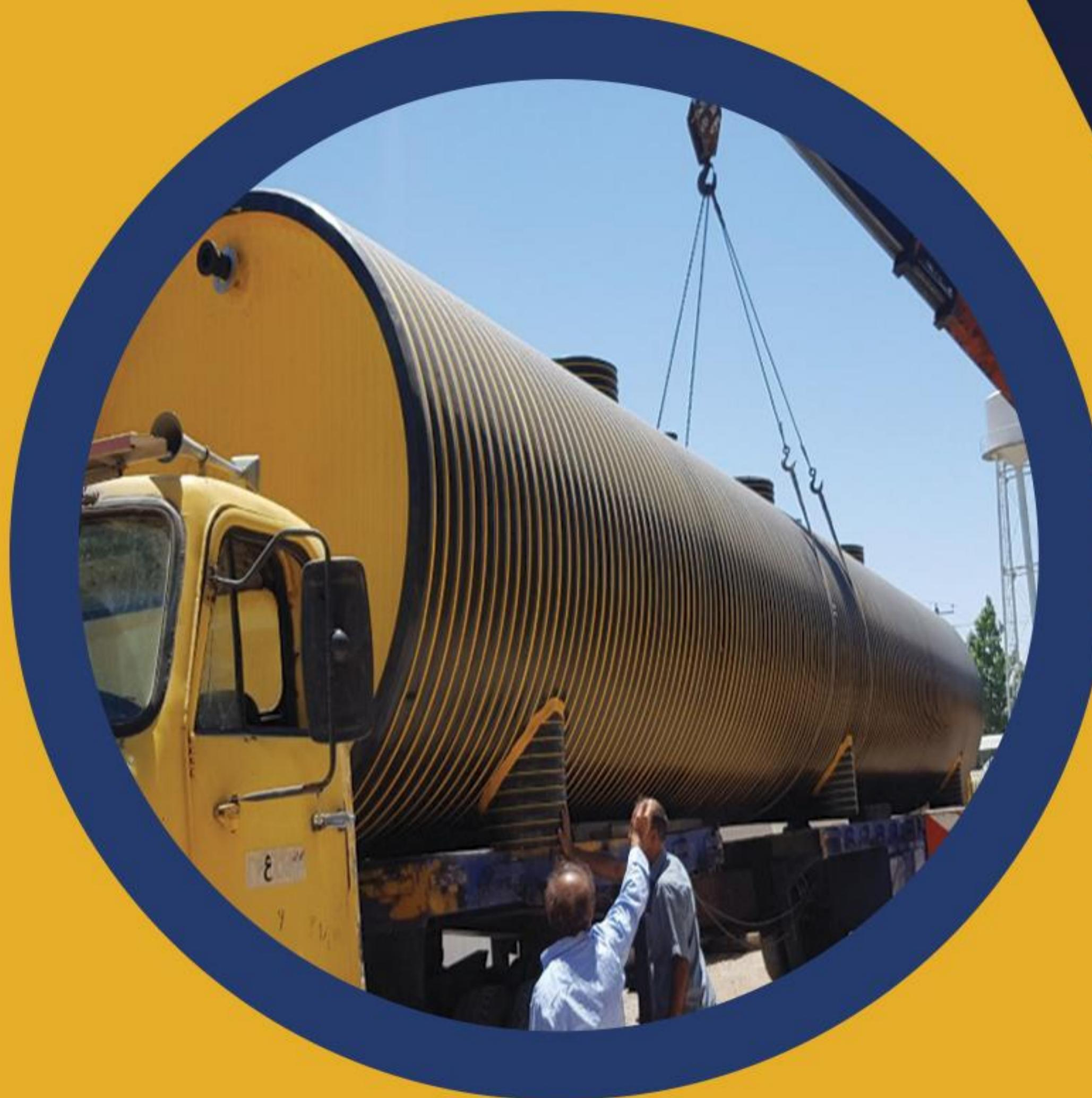
مخازن تولید شده شرکت صنایع لوله های آبرسانی دارای پروفیل بدن از جنس لوله پلی اتیلن با دیواره ساختمند و مقاوم به روش اسپیرال کاروگیت تولید می شود.
