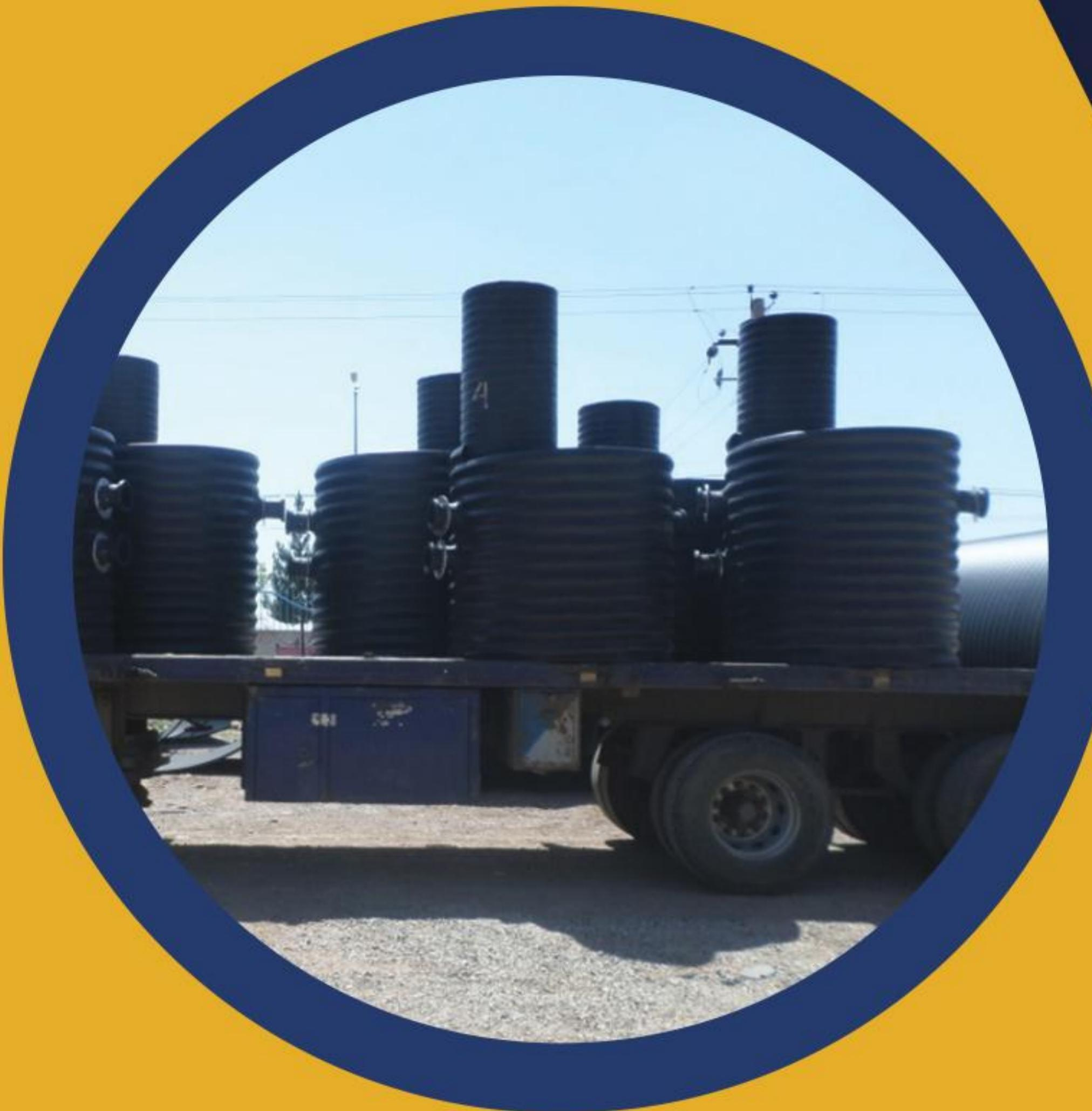
منهول های تولید شده شرکت صنایع لوله های آبرسانی شامل یک بدن اصلی از لوله های اسپیرال کاروگیت که متناسب با محل قرارگیری منهول و بارترافیکی که به آن وارد می شود طراحی می شوند ، یک عدسی در کف یکی در بالای مخزن بدن همراه با دریچه بازدید می باشد.
